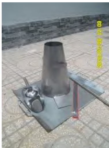
CÔN THỬ ĐỘ SỤT BÊ TÔNG
