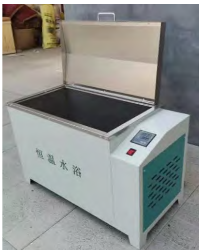
BỂ ÔN NHIỆT BÊ TÔNG NHỰA
